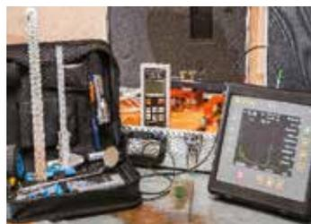
**Контроль сварных соединений (ультразвук, визуальный контроль)**
