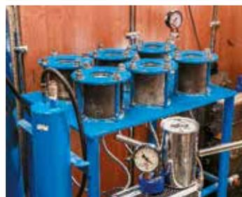
**Определение водонепроницаемости бетона (базовый, ускоренный методы)**
