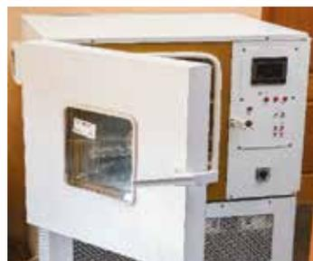
**Определение морозостойкости бетона**
